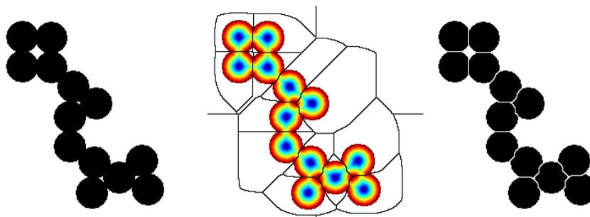
**Figure 9.4.** – Application de la ligne de partage des eaux pour séparer des particules connectées. (a) Image d'origine (b) fonction distance inversée et ligne de partage des eaux sur la fonction distance (c) séparation des particules.
